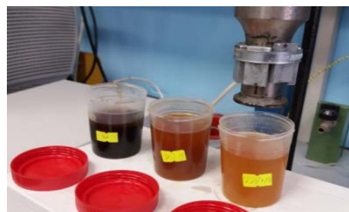
Рисунок 4. Визуальный эффект обработки погонов подсолнечного масла: 1 – без обработки; 2 – обработка в ультразвуке; 3 – обработка в ультразвуке с закрепленными магнитами
