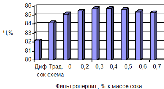
Рис. 1. Зависимость чистоты преддефекованного сока от массовой доли фильтроперлита, добавляемого в диффузионный сок совместно с 0,4% пищевых волокон
