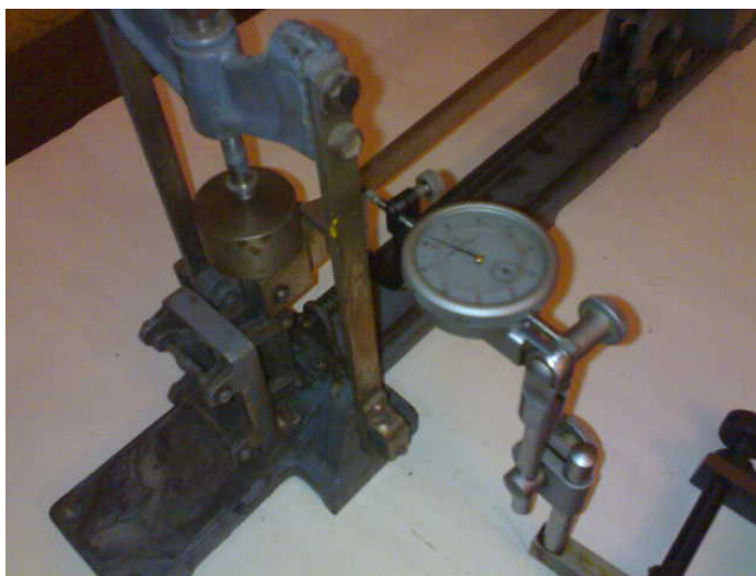
Рисунок 4 - Прибор с микрометром для определения величины деформации зерна
