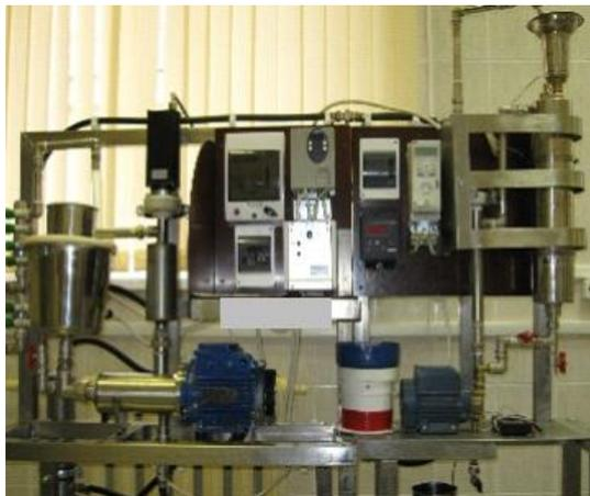
Рисунок 3. Лабораторная кавитационная установка – здесь осуществляется распределение скорости потока и распределение давления
