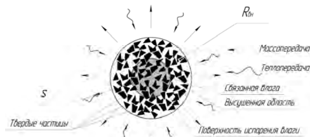
Рисунок 2. Капля в период убывающей скорости сушки
