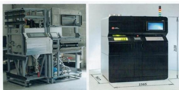
Рисунок 6. Внешний вид и размеры SLM установки [16]
