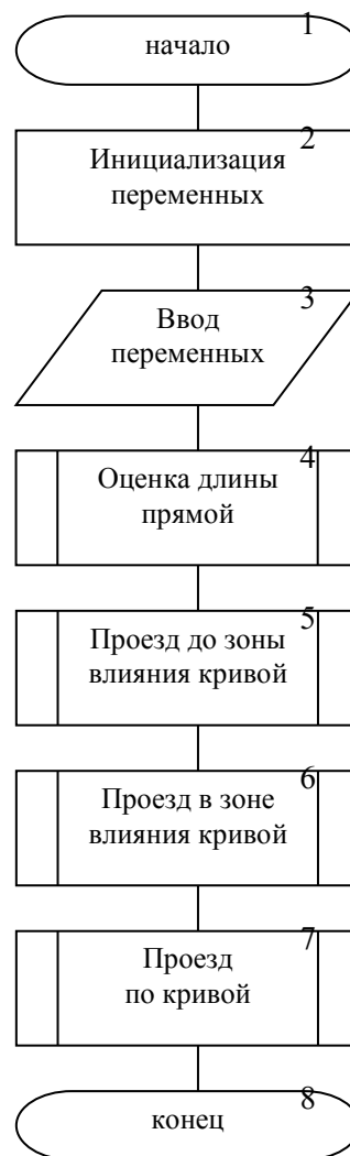
Рисунок 1. Блок-схема расчёта скорости движения в плане
