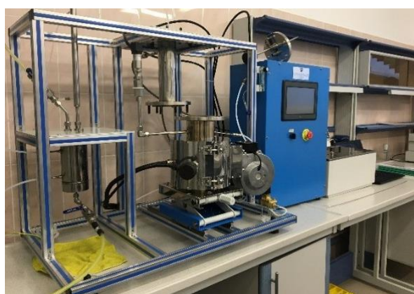
Рисунок 3. Фото лабораторной установки получения жидкого диоксида серы Figure 3. Photo of a lab unit for the production of liquid sulfur dioxide
