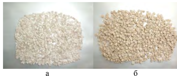
Рисунок 1. Внешний вид гранул полимерных композиций для биофильтров с улучшенными иммобилизационными свойствами:
