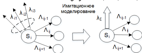
Рисунок 11. Снижение размерности моделирования путем объединения нескольких простейших потоков Figure 11. Simulation dimension reduction by combining several simple streams
