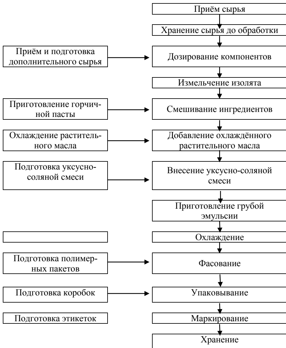
Рисунок 10. Технологическая схема производства бесхолестеринового майонеза на основе мяса сайки
