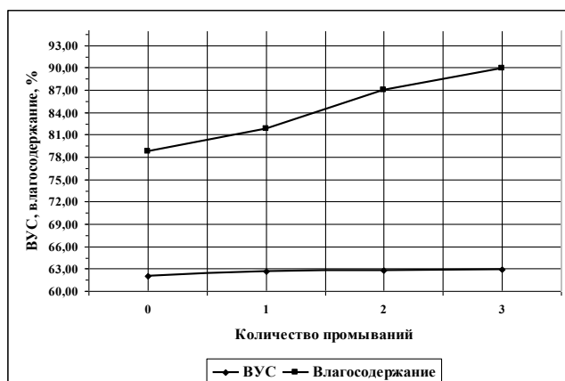
Рисунок 2. Изменение влагоудерживающей способности и влагосодержания в зависимости от количества промываний
