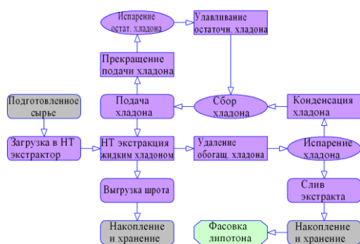
Рис. 5. Схема технологического процесса экстракционного извлечения липофильной фракции сжиженными газами
