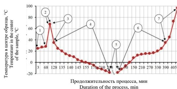
1 – замес, брожение, разделка, формование, расстойка (тестовой заготовки массой 0,07 кг); 2 – выпечка (до готовности на 70–75 %); 3 – охлаждение (до 35 °С); 4 – замораживание; 5 – хранение; 6 – размораживание; 7 – допекание
