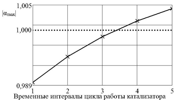
Рис. 6. Зависимость максимальных значений корней в течение всего цикла работы катализатора
