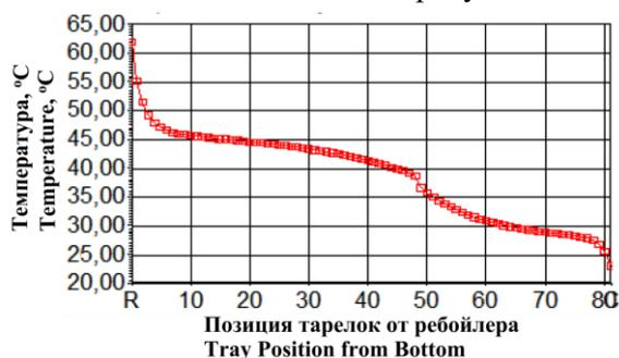
Рисунок 4. График изменения температуры по высоте колонны ДИП
