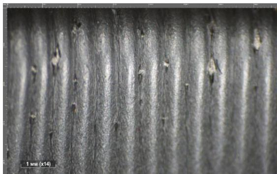
Рисунок 2. Разрывы лакокрасочного покрытия в зоне морщин
