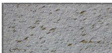
Рисунок 4. Разрушение лакокрасочного покрытия и коррозия после стерилизации в 3% растворе пищевой соли
