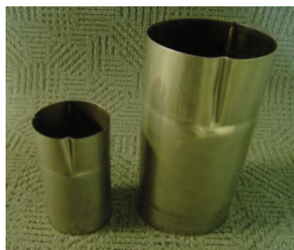
Рисунок 2. Потеря устойчивости стенкой трубы при калибровке обжатием
