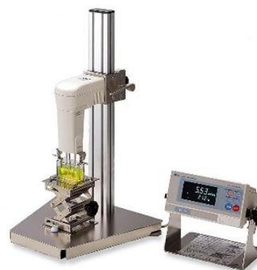
Рисунок 2. Вибрационный вискозиметр
