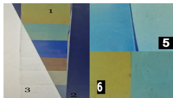
Рисунок 1. Фотографии стопы Столетова из ТУ пленки поливинилхлорида в поляризованном свете (1). Пленочный поляризатор (2). Стопа Столетова без поляризатора (3). Изменение цвета 5-го и 6-го слоев пленки в стопе Столетова после обработки 1,2 – дихлорэтаном
