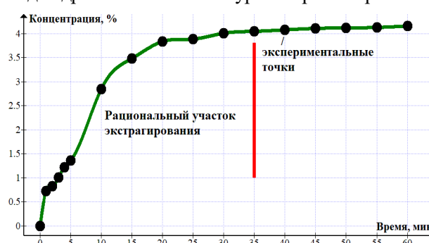
Рисунок 3. Результаты экспериментальных исследований процесса экстрагирования водорастворимых веществ из мякоти хурмы сорта «Королек»
