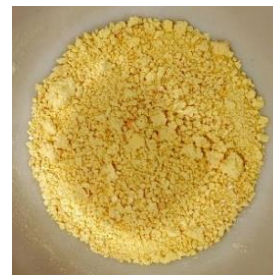
Рисунок 1. Фотография оксида висмута после прокаливания
