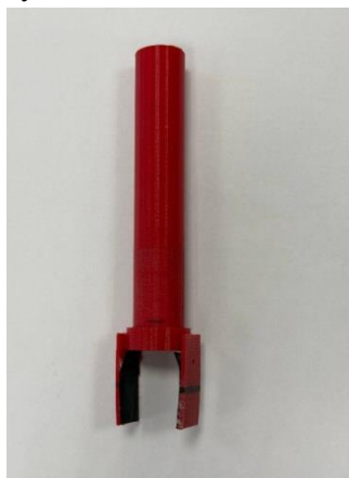
Рисунок 1. Измерительная ячейка, напечатанная на 3D-принтере
