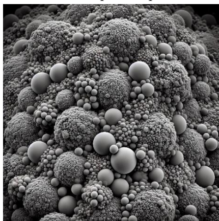
Рисунок 2. СЭМ изображение дисперсии оксикарбида кремния (SiOC)
