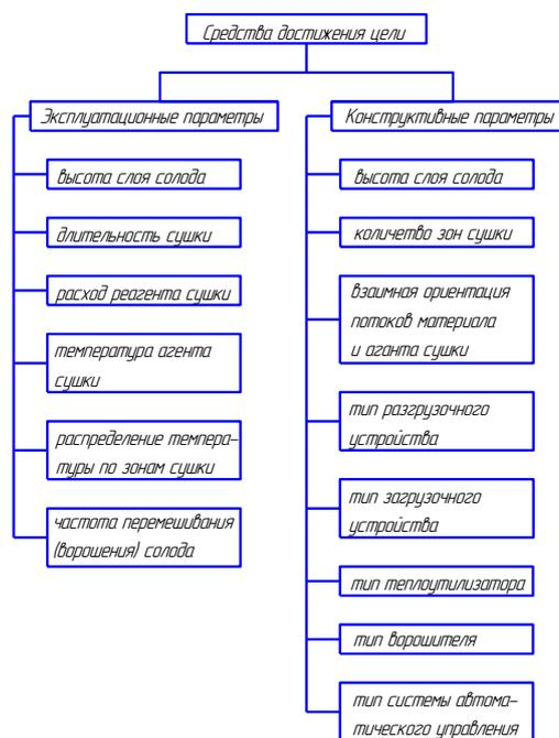
Рисунок. Средства повышения интенсивности конвективной сушки
