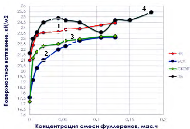
Рисунок 1 Зависимость величины поверхностного натяжения от концентрации смеси фуллеренов для исходных НК(1), БСК (2), СКЭПТ (3), ПБ (4)
