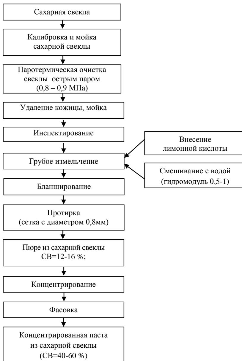
Рисунок 1. Структурная схема производства концентрированной пасты из сахарной свеклы
