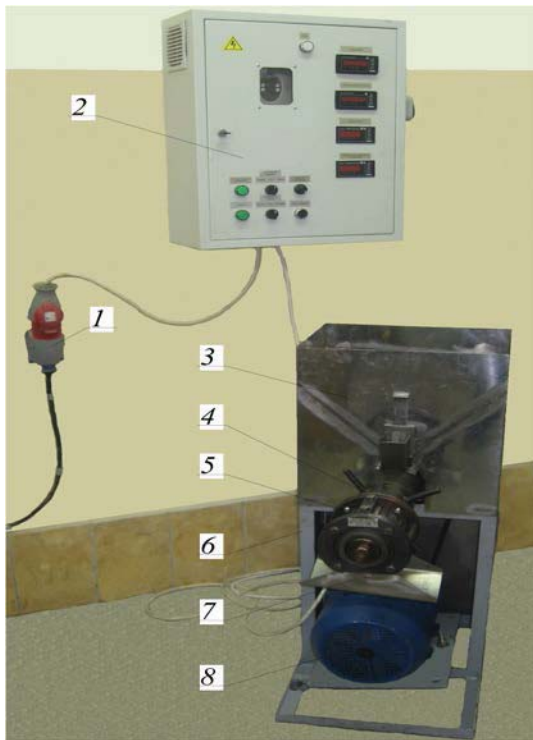
Рис. 1. Экспериментальная установка МПЭ-1: 1 – источник электропитания; 2 – щит управления; 3 – загрузочный бункер; 4 – орган регулировки зазора; 5 – зерновая камера; 6 – станина; 7 – сборник масла; 8 – электропривод
