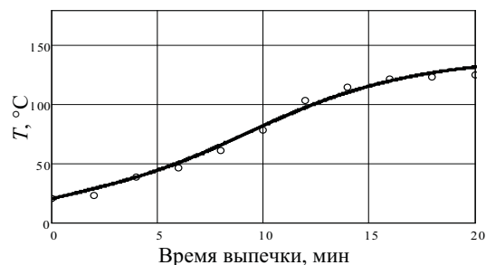
Рис. 5. Результат идентификации моделью (5) экспериментальных значений для температуры корки: \circ\circ\circ — экспериментальные; — — расчетные значения температуры корки
