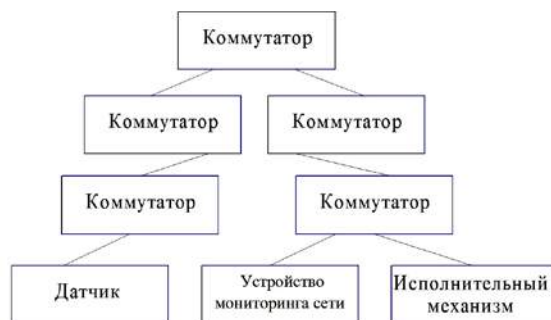
Рисунок 4 - Схема подключения в случае, когда между датчиком и устройством управления находятся шесть коммутаторов
