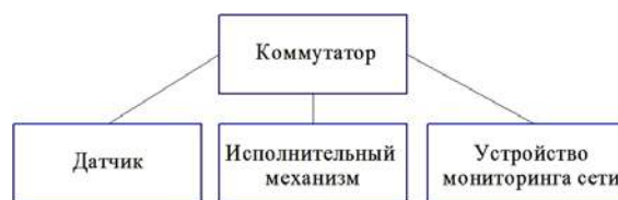
Рисунок 2 - Схема подключения в случае, когда между датчиком и устройством управления находится один коммутатор
