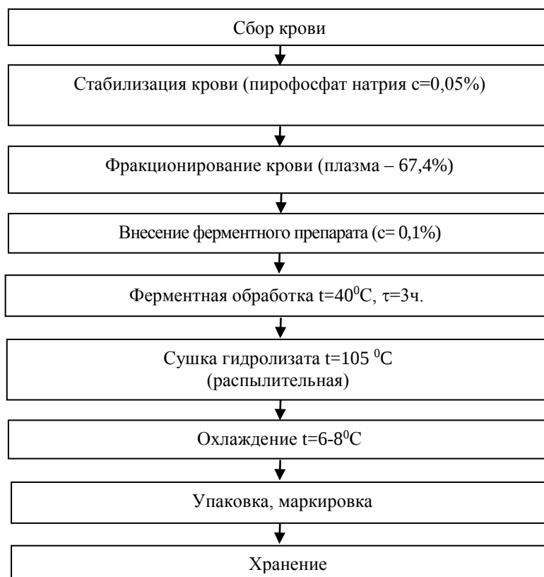
Рисунок 4. Технологическая схема производства кормового гидролизата плазмы крови
