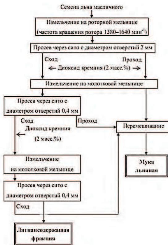
Рисунок 5. Технология получения лигнансодержащей фракции и муки льняной
