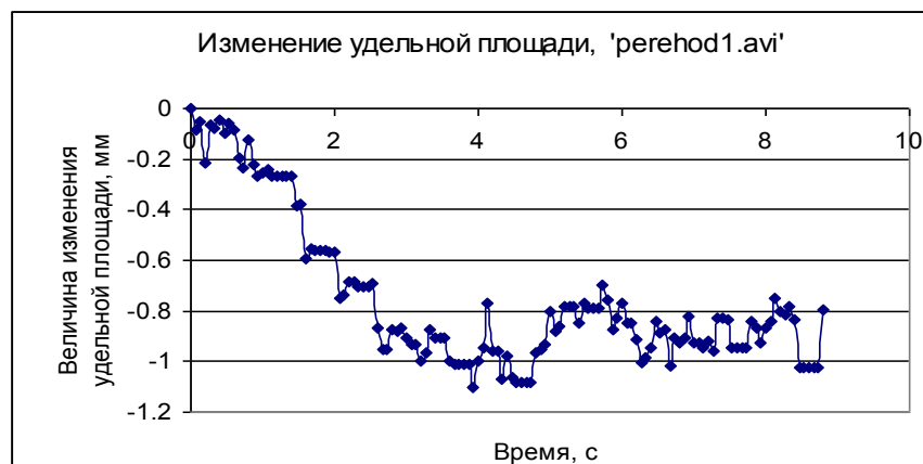
Рисунок 2. Изменение удельной площади при увеличении скорости нагнетания комбикормовой массы
