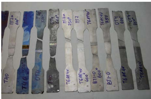
Рисунок 2. Типичный вид разрушений, на примере опытных образцов из титановых сплавов
