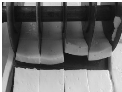
Рис. 1. Адгезионное разрушение при формовании комбинированных корпусов методом размазки и резки
