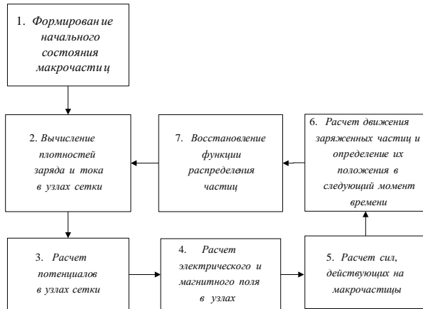
Рисунок 2. Расчетная схема метода крупных частиц
