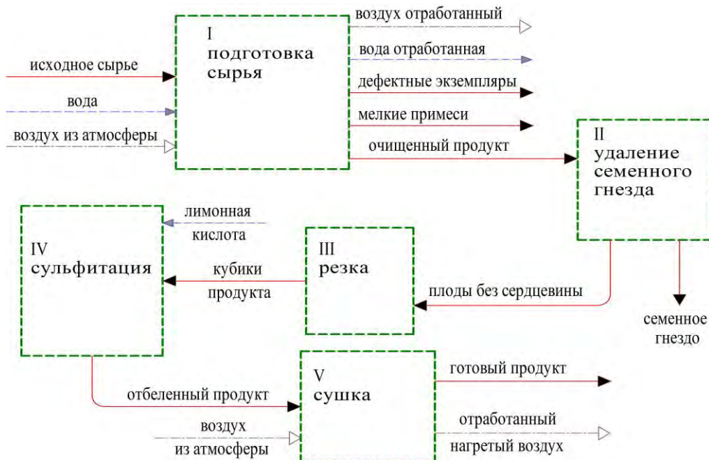
Рисунок 2. Схема обмена потоками между контрольными поверхностями предлагаемой теплотехнологической системы: — — — — — продукт; — — — — — вода; — — — — — воздух; — — — — — электроэнергия; — — — — — границы контрольных поверхностей
