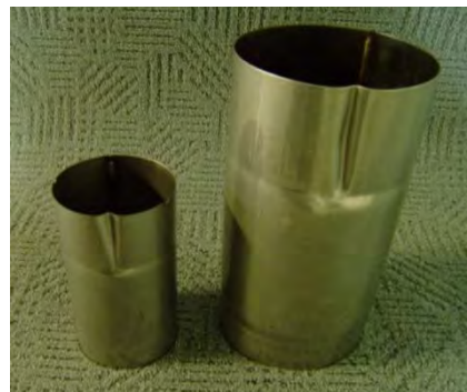
Рисунок 2. Потеря устойчивости стенкой трубы при калибровке обжатием
