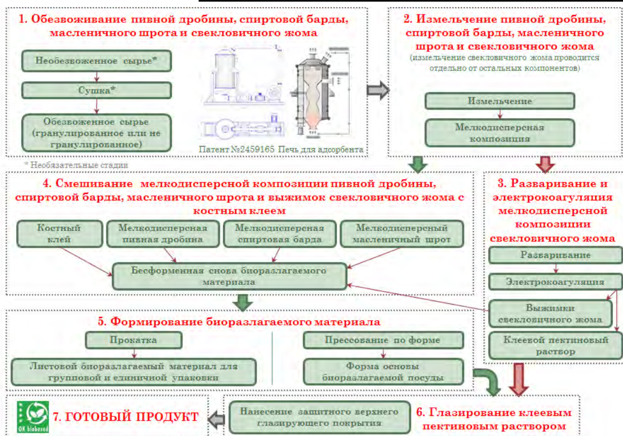
Рисунок 3. Технологическая схема производства биоразлагаемой упаковки из вторичных материальных ресурсов пищевых производств
