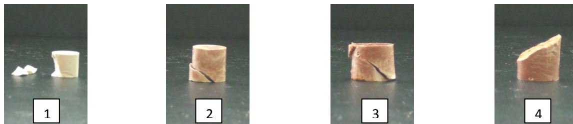
Рисунок 5. Характер разрушения ПА-6 (1) и композитов на его основе, содержащих 15 (2), 30 (3) и 45 (4) мас.% волокна аримида-Т
