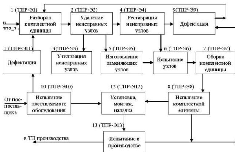
Рисунок 5 - Структура технологического процесса ремонта энергооборудования (ТПР_Э)
