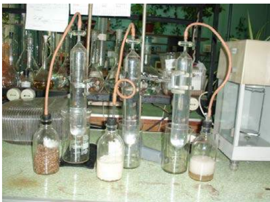
Рисунок 1 – Определение газовыделения в условиях ограниченного доступа кислорода
