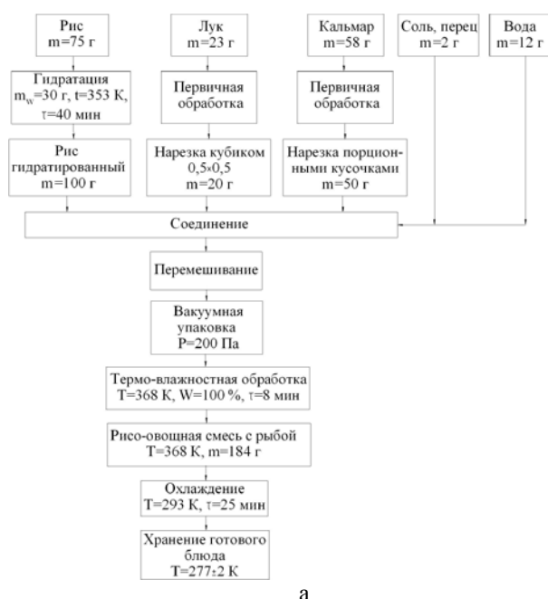
Рисунок 7. Рецептурно-технологическая схема производства рисо-овощных смесей с гидробионтами: а – с кальмаром; б – с карпом
