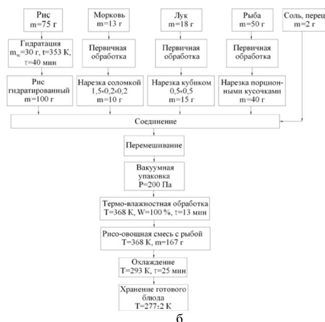
Рисунок 7. Рецептурно-технологическая схема производства рисо-овощных смесей с гидробионтами: а – с кальмаром; б – с карпом
