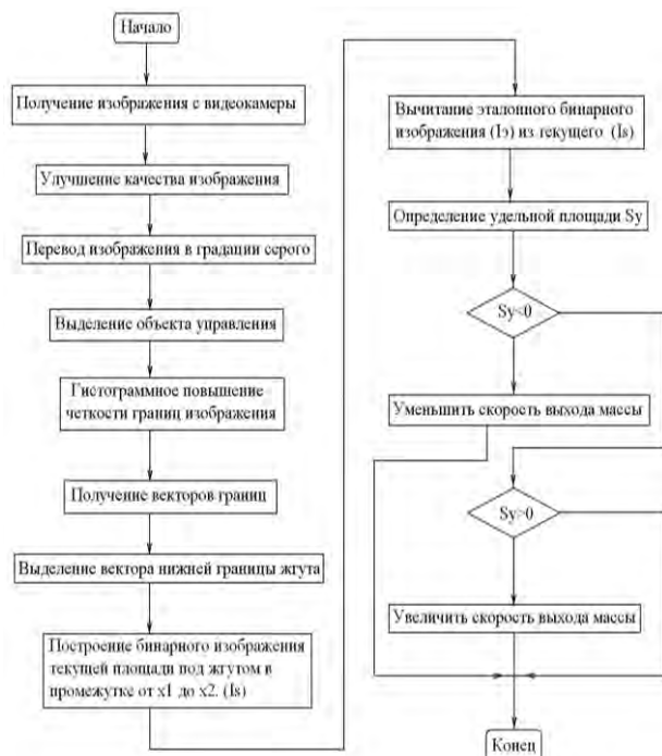
Рисунок 3. Блок-схема алгоритма управления, на основе которого интеллектуальная система принимает решение об изменении регулирующих воздействий
