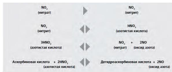
Рисунок 4. Редуцирование нитрата и образование оксида азота
