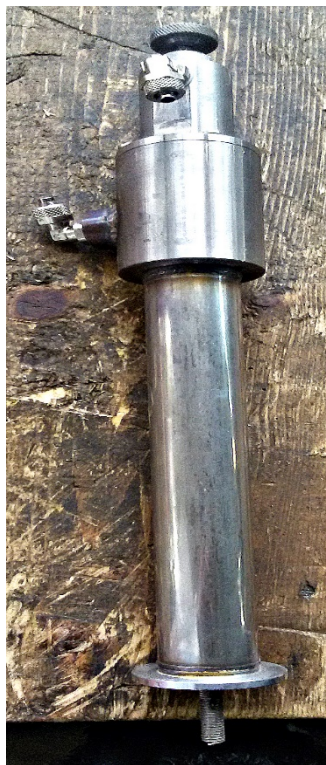
Рисунок 3. Модель струйно-барботажного сатуратора
