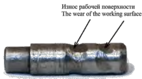
Рисунок 2. Штифт с износом
