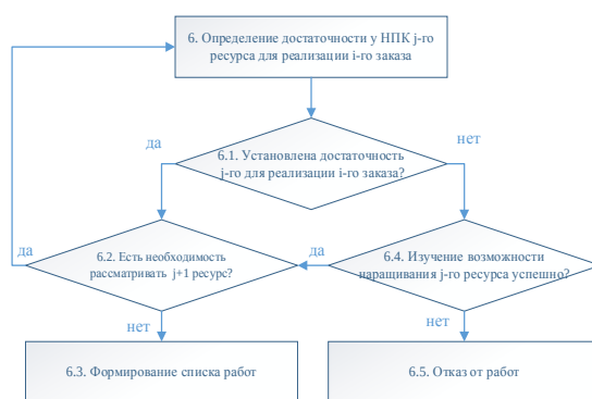
Рисунок 3. Алгоритм установления достаточности потенциала НПК для реализации i -го заказа
