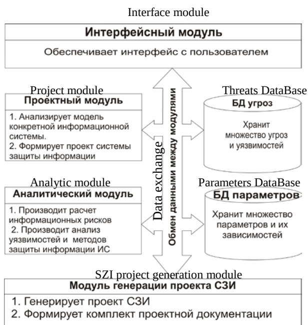
Рисунок 3. Функциональная схема программного комплекса проектирования КСЗИ
