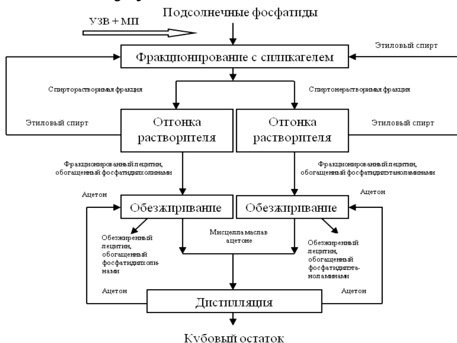
Рисунок 2. Технология получения модифицированных подсолнечных лецитинов Figure 2. Technology of production of modified sunflower waste of deodorization
