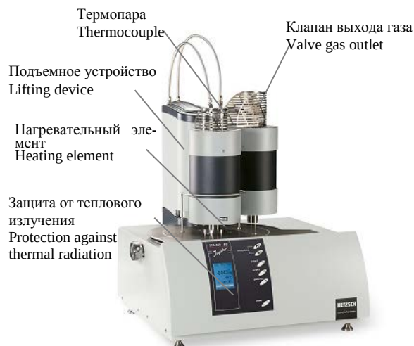
Рисунок 1. Прибор синхронного термического анализа (TG-DTA/DSC) модели STA 449 F3 Jupiter Figure1. Device simultaneous thermal analysis (TG-DTA/DSC) model STA 449 F3 Jupiter
