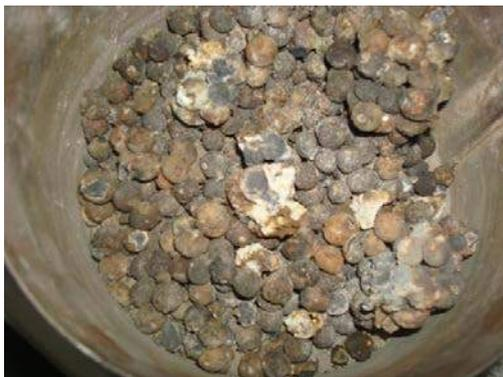
Рисунок 3. Агломерационный НРС после высокотемпературной обработки
