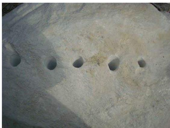
Рисунок 7. Бурение шпуров в негабаритном куске горной породы
