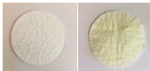
Рисунок 2. Кембриджский фильтр до и после прокуривания одного образца кальянной смеси на курительной машине Cerulean SM405
