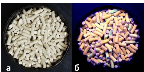
Рисунок 5. Внешний вид композита из люминофора и ПВХ матрицы: a – при дневном освещении; b – при освещении лампой Camelion FT5 BLACK LIGHT
