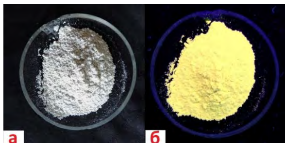
Рисунок 2. Внешний вид порошка люминофора при дневном (а) и УФ освещении лампой Camelion FT5 BLACK LIGHT (б)
