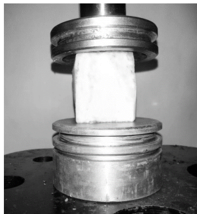
Рисунок 2. Испытание на сжатие образца свеклы, обработанного раствором сульфата аммония
