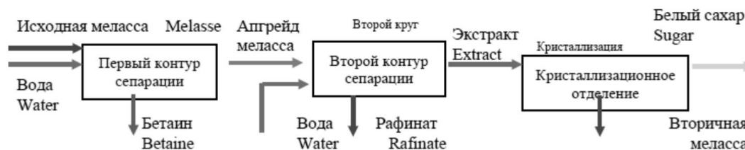
Рисунок 3. Технологический поток системы с сопряженным контуром
